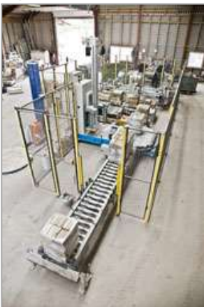
Murstenene stables og pakkes af robotter
